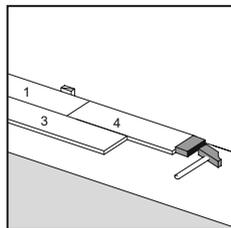
Способ В: система Uniclic® позволяет соединить панели, постукивая по ним подбойником и не приподнимая их. Для этого способа требуется использовать специальный блок для постукивания Uniclic®. Не следует соединять планки одним ударом. Во избежание повреждения панелей их необходимо соединять вместе, постепенно обстукивая.
